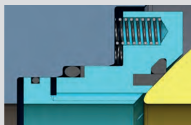
Rys. 3a PMSS siedlisko z elastomerem i termoplastycznego
