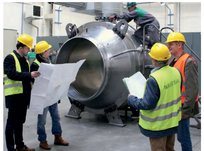
Odbiór kurek kulowy DN 1400 AG dla Eustream, Słowacja
